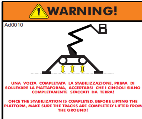
Afbeelding 64: waarschuwing voor stijging rupsbanden.
